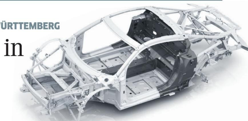
Der Audi Space Frame des Audi R8 bringt nur 200 Kilogramm auf die Waage
